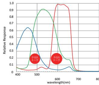
染料で着色されたカラーフィルタを用いるため、画素同士の波長分布が重なり、クロストークが発生します。
