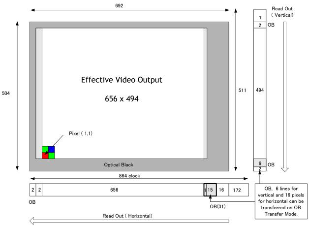
Fig. 15. CCD sensor layout
