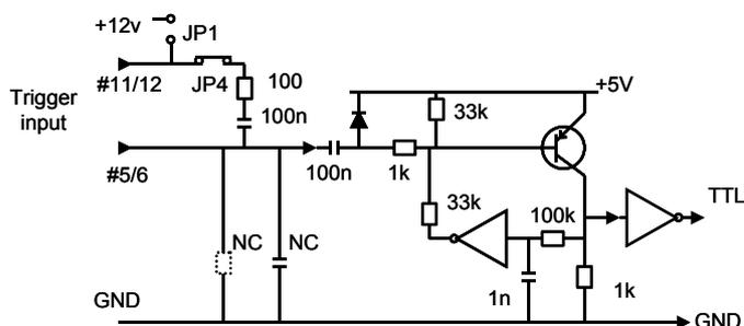
Fig. 5. Trigger input.
